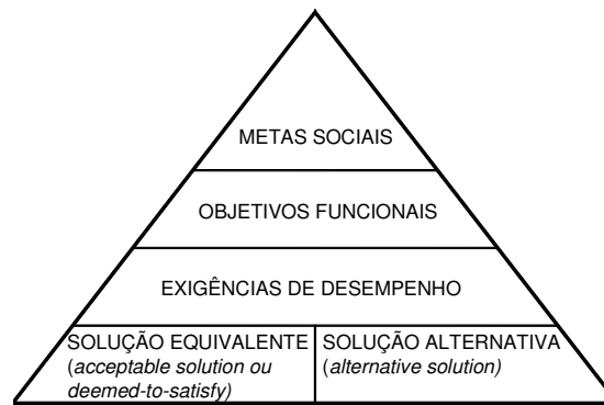
Figura 2.10 Estrutura hierárquica típica dos principais componentes do sistema PBD
