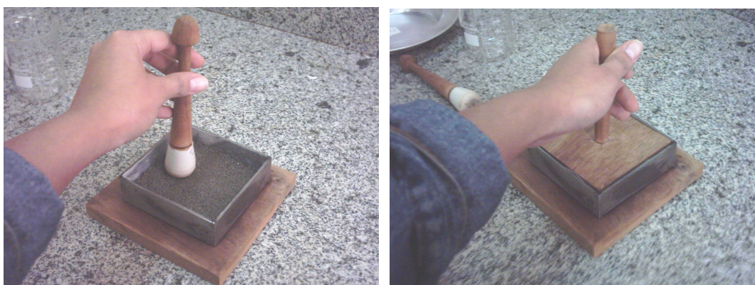
Figura 4.3 – Moldagem das camadas com o auxílio de soquete e do extrator de amostra.
