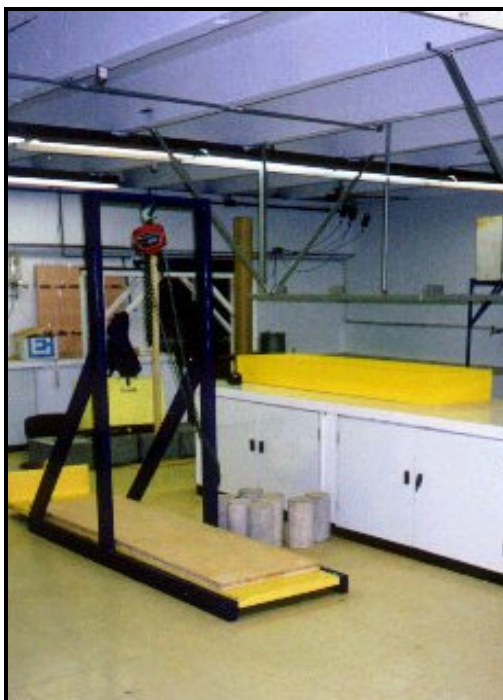
Figura 4.14 - Equipamento para ensaios de plano inclinado (Fonte: Lima Jr, 2000).
