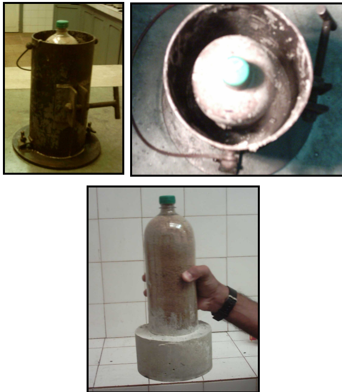
Figura 6.38– Processo de desmoldagem da garrafa.
