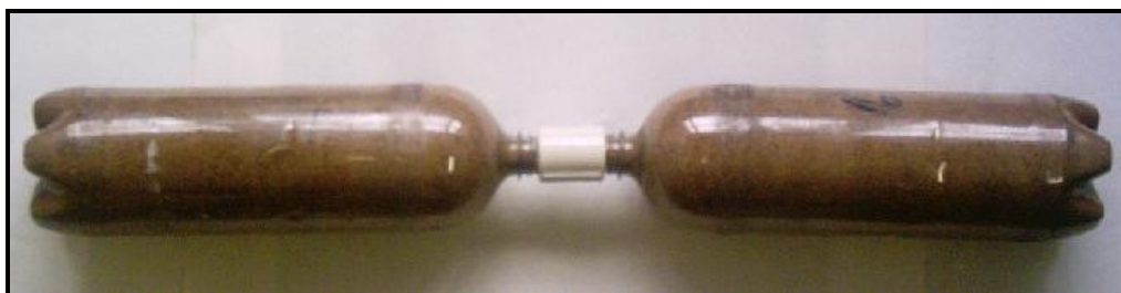
Figura 5.3 – Configuração em duas garrafas para Muro PET.
