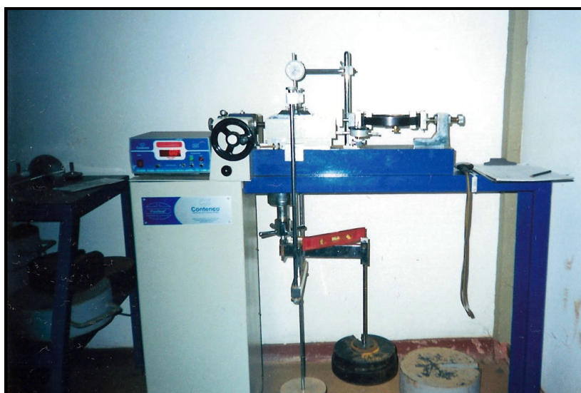
Figura 3.10: Prensa de cisalhamento.
