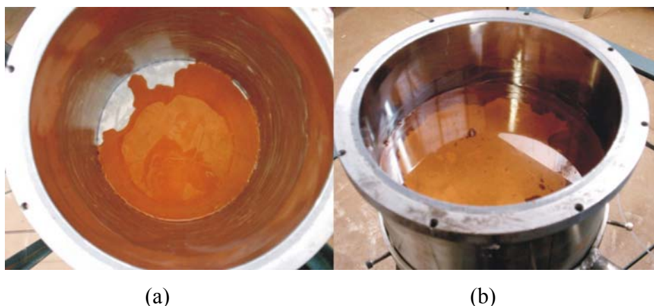
Figura 3.12 – (a) Início da colocação da lama no consolidômetro e (b) condição da lama após sedimentação e adensamento por peso próprio.
