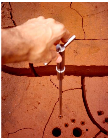
Figura 3.48 – Obtenção do perfil de resistência através do ensaio de palheta.
