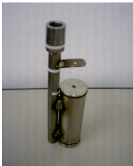
Figura 3.44 – Amostrador do tipo caneco.
