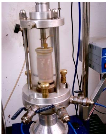
Figura 3.25 – Ensaio triaxial do tipo UU.
