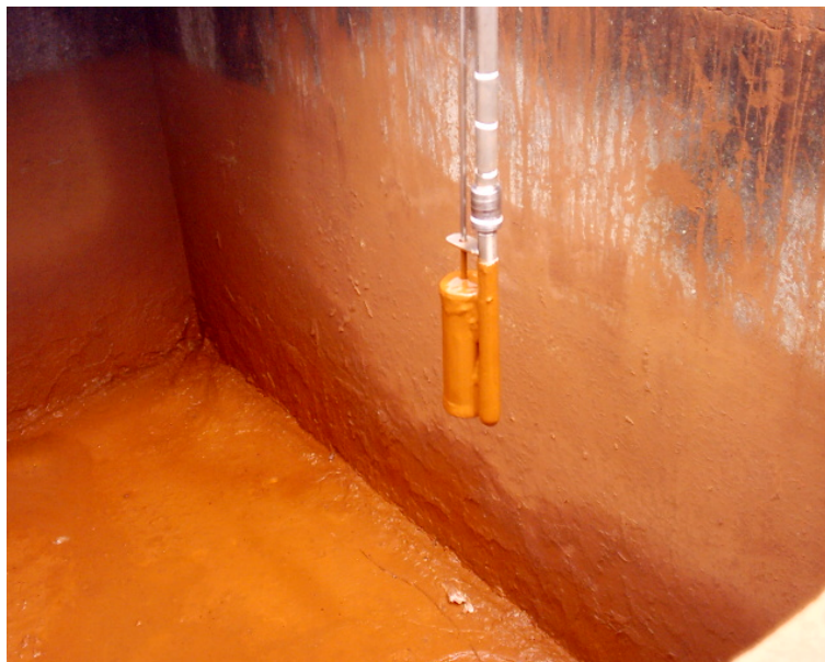
Figura 3.46 – Amostragem com o amostrador do tipo caneco.
