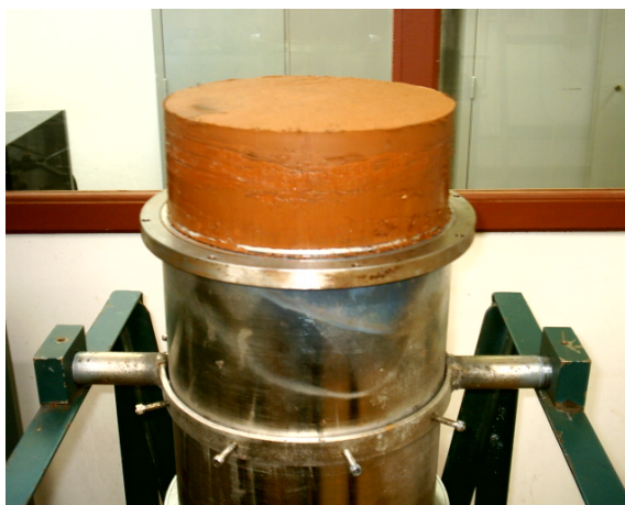
Figura 3.24 – Condição final da amostra fabricada para a realização de ensaios UU.
