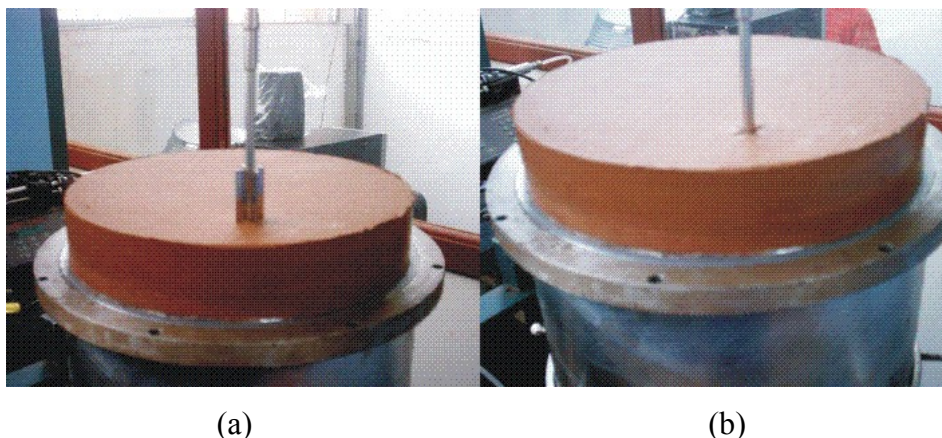
Figura 3.20 - (a) penetração da palheta e (b) aplicação do torque.
