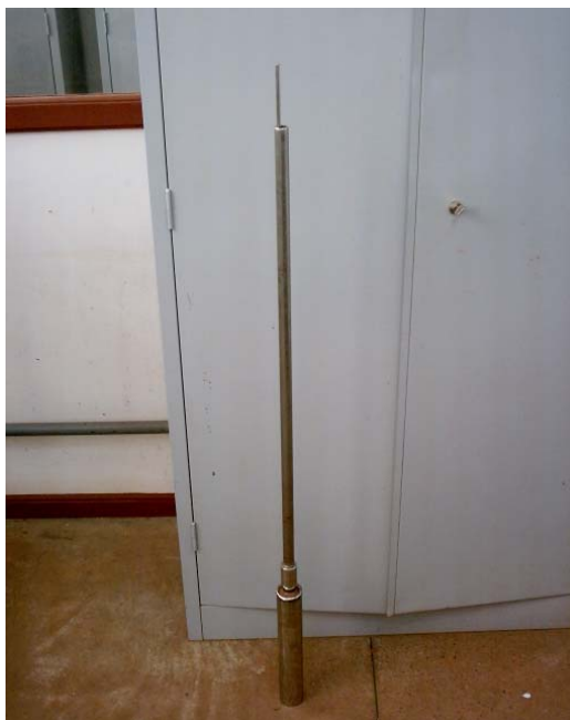
Figura 3.45 – Amostrador do tipo pistão.
