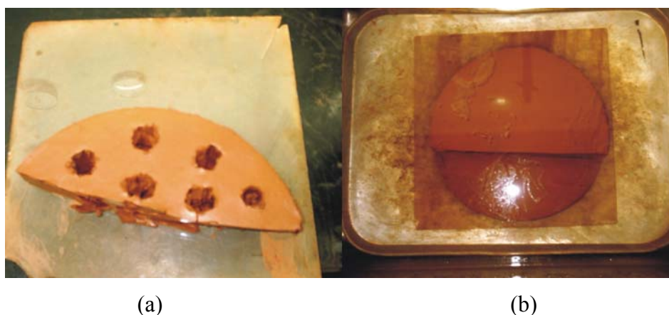
Figura 3.22 – (a) amostra utilizada na pesquisa da influência da velocidade e (b) amostra de lama submersa.
