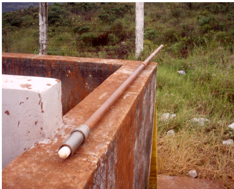
Figura 3.34 – Conjunto utilizado no monitoramento da poropressão.
