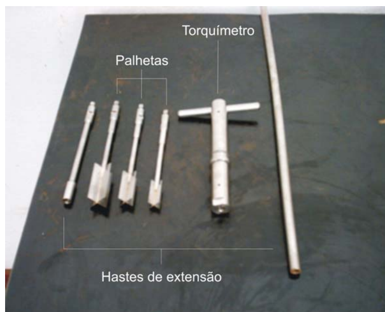
Figura 3.18 – O equipamento palheta.
