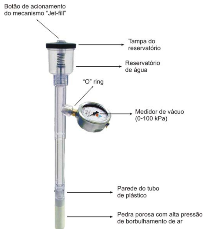
Figura 3.41 – Tensiômetro do tipo Jet Fill.
