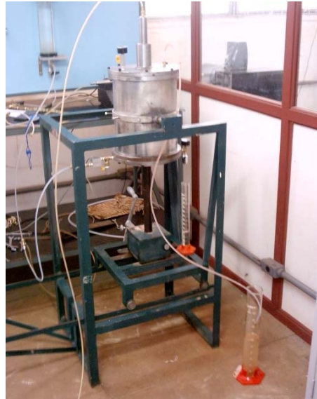
Figura 3.15 – Ensaio no consolidômetro de lama.
