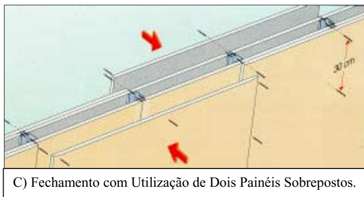
Figura 3.5C – Colocação das Chapas de Gesso.
