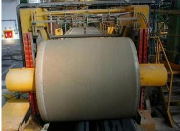
Figura 6.13- Foto frontal do cilindro prensado da máquina Hatschek.
