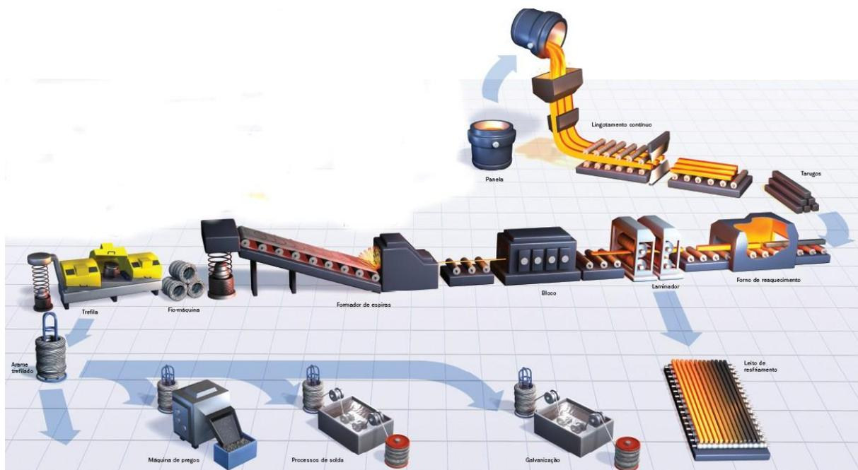
Figura 5.7: Esquema das etapas de laminação.
