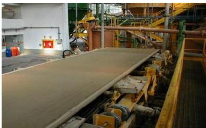
Figura 6.12- Foto da vista superior da máquina Hatschek: formação de películas
