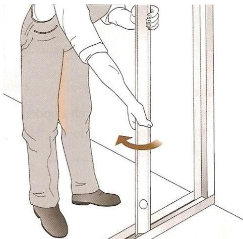
Figura 6.8- Esquema de colocação de montantes.
