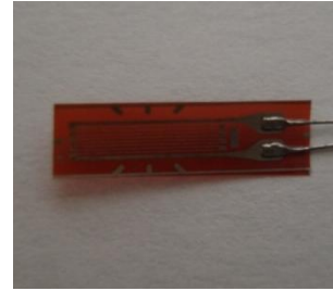
(c) Roseta colada no protótipo.
