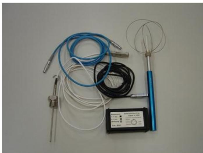
Figura 4.15 – Termo anemômetro FV A605 TA, ALMEMO
