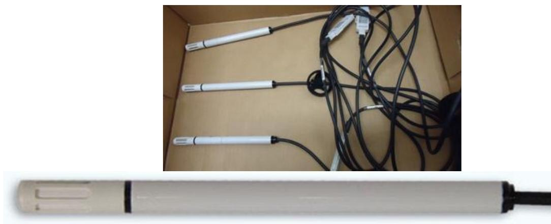
Figura 4.13 – Sensor de temperatura e umidade Modelo ALMEMO
