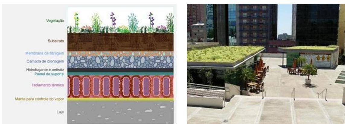
Figura D.2- Detalhamento das camadas e exemplos do telhado verde plano.
