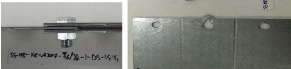
Figura 4.6 – Falha por rasgamento entre furo e borda da amostra SS-118-A307 (Sheerah – 2009)
