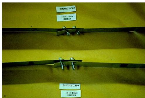
Figura 4.7 – Falha por esmagamento do furo/inclinação excessiva (*tilting*) em ligação com 4 parafusos dispostos em "quadrado" (Rogers e Hancock, 1997)
