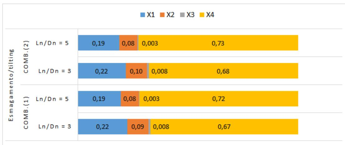
Figura 5.31 – Coeficientes de sensibilidade para ligações com PAA considerando esmagamento/*tilting*
