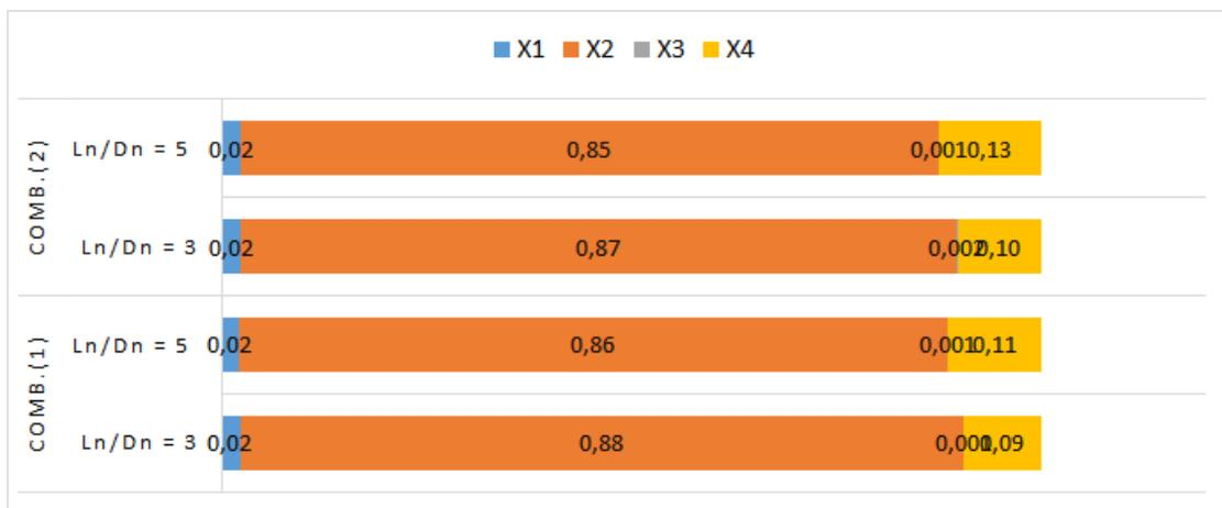
Figura 5.15 – Coeficientes de sensibilidade para ligações parafusadas considerando EPF em perfis U
