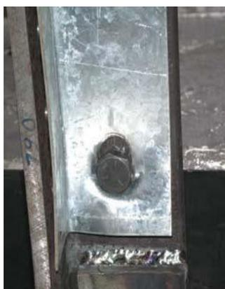
Figura 4.5 – Esmagamento da parede do furo em ensaio de Maiola (2004)
