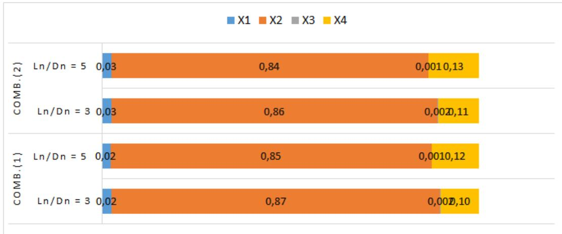
Figura 5.13 – Coeficientes de sensibilidade para ligações parafusadas considerando EPF todos os dados de chapas (Maiola)
