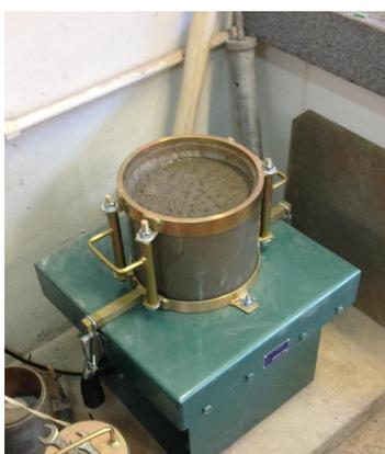
**Figura 4.14.** Final do ensaio de trabalhabilidade
