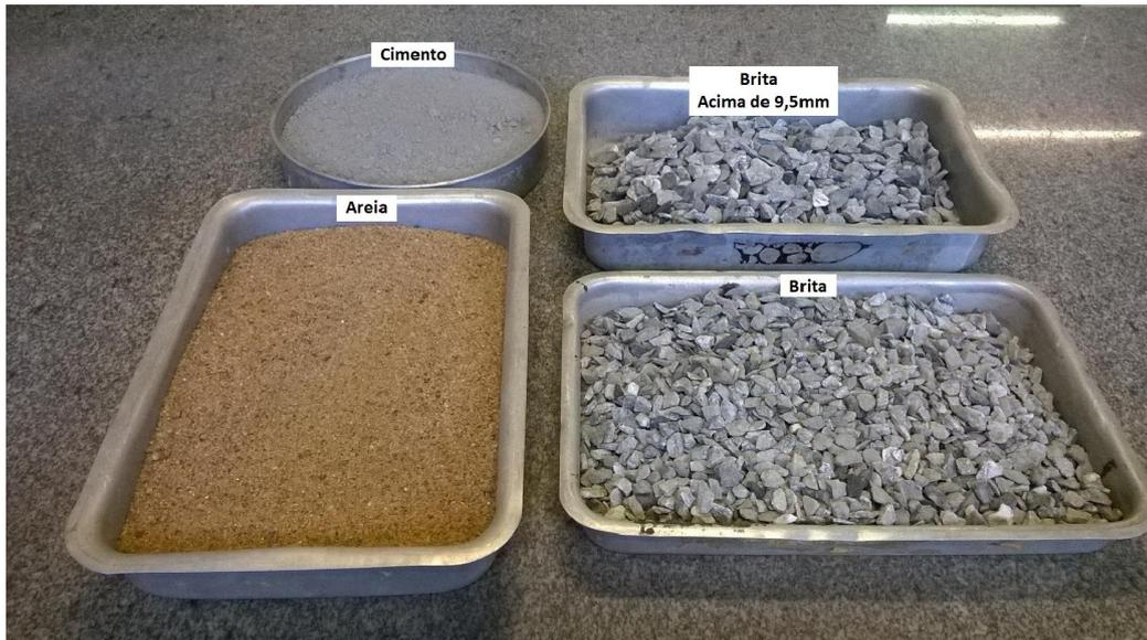
**Figura 4.2.** Materiais utilizados com agregados naturais
