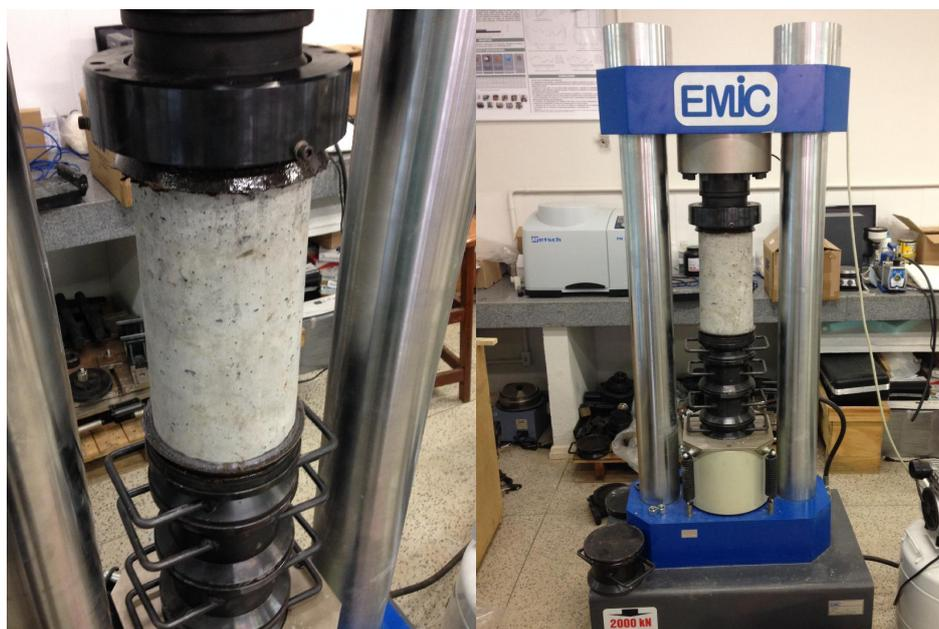
Figura 4.17. Ensaio de compressão simples
