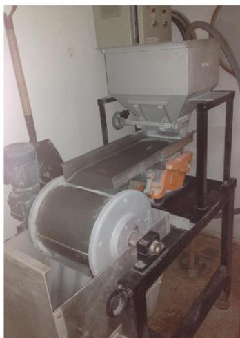
**Figura 4.4.** Equipamento utilizado para a separação magnética
