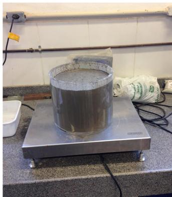
**Figura 4.15.** Massa do CCR após compactação da mesa Vebê
