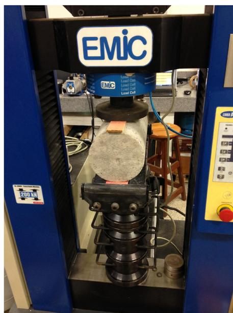
**Figura 4.19.** Ensaio de resistência à tração por compressão diametral
