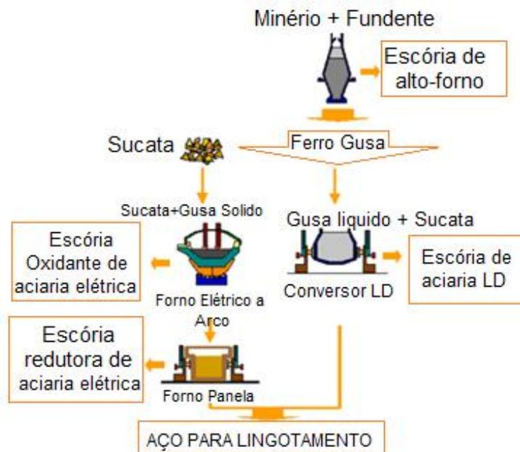
**Figura 2.3.** Esquema simplificado para produção do aço
