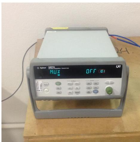
**Figura 4.20.** Datalogger Agilent 34972A utilizado para a leitura das deformações dos extensômetros
