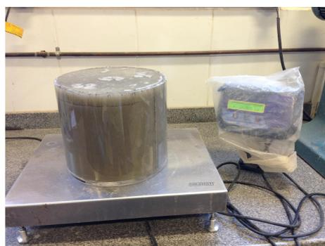
**Figura 4.16.** Massa com água do CCR após compactação da mesa Vebê
