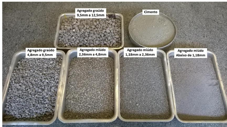
**Figura 4.5.** Materiais utilizados com agregados de escória LD
