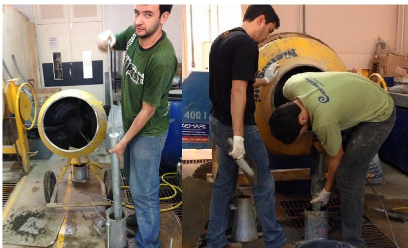
**Figura 4.12.** Execução dos ensaios de umidade ótima - Soquete e Martetele
