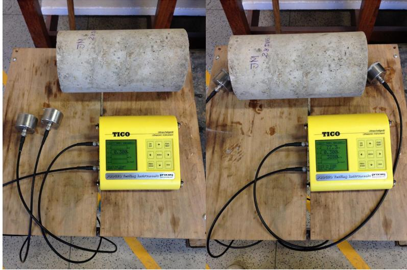
**Figura 4.22.** Ensaio de velocidade de onda ultra-sônica e módulo de elasticidade dinâmico
