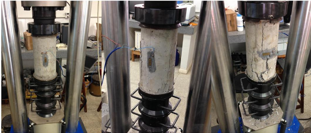
**Figura 4.21.** Ensaio de módulo de elasticidade estático
