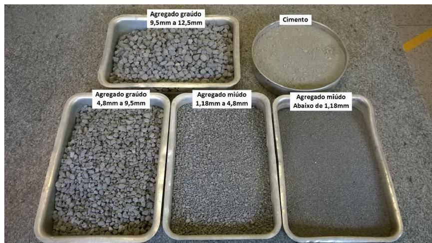
**Figura 4.6.** Materiais utilizados com agregados de escória elétrica
