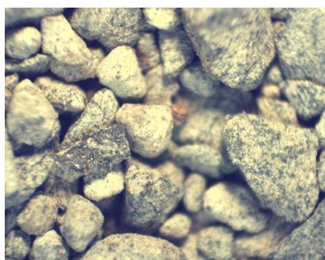
**Figura 5.11.** Morfologia do agregado miúdo de escória elétrica
