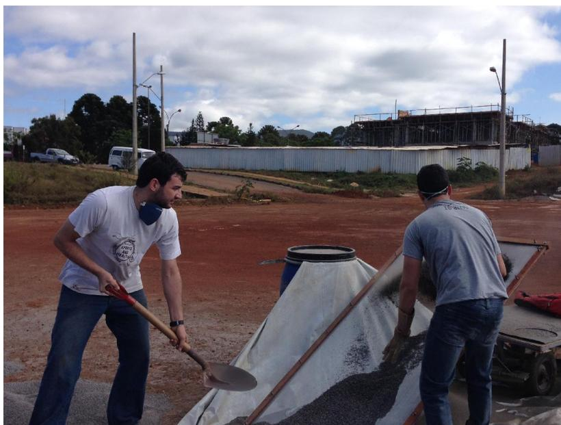
**Figura 4.3.** Peneiramento das frações miúdas das escórias de aciaria elétrica e LD
