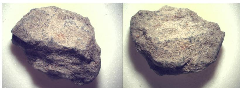
**Figura 5.12.** Morfologia do agregado graúdo de escória elétrica
