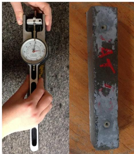
**Figura 4.23.** Ensaio de expansibilidade
