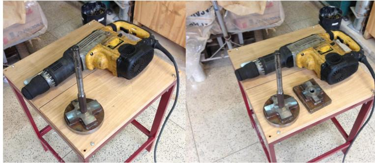
Figura 4.10. Martetele com as placas de compressão
