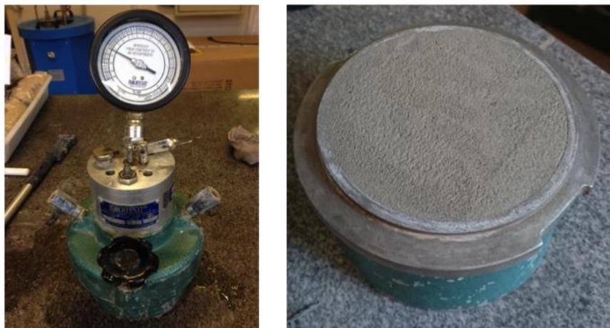
Figura 13: Equipamento Teor de Ar Incorporado
