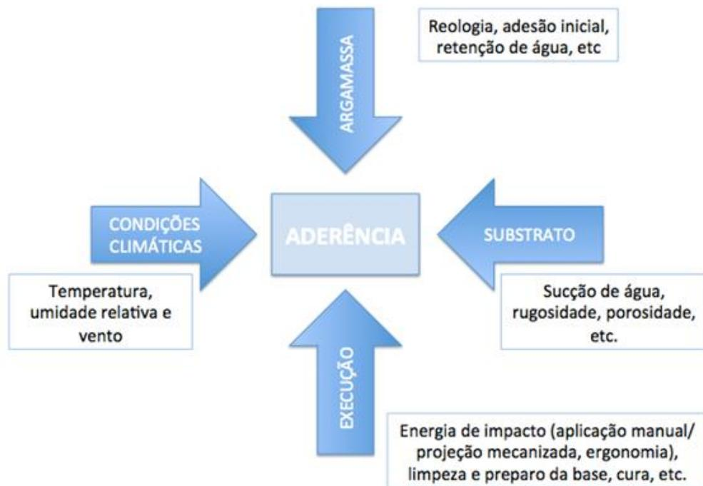
Figura 2: Fatores que exercem influência na resistência de aderência de argamassas colantes
