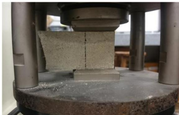
Figura 18: Procedimento Resistência à Compressão
