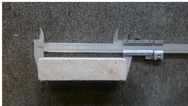
Figura 19: Procedimento Densidade de Massa no Estado Endurecido
