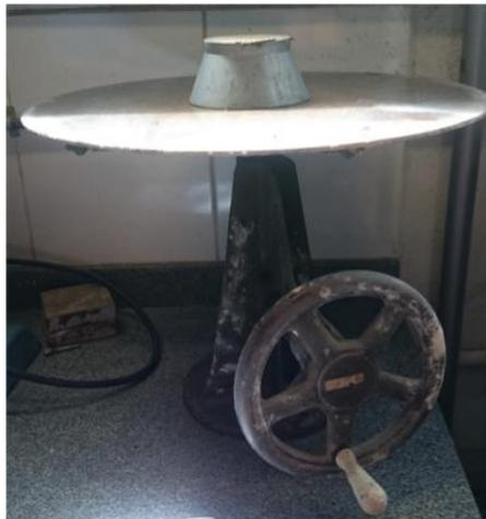
Figura 9: Procedimento Índice de Consistência
