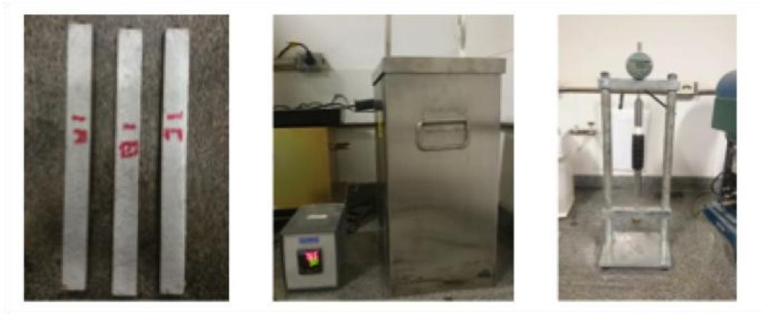
Figura 21: Procedimento Expansibilidade das Barras de Argamassa
