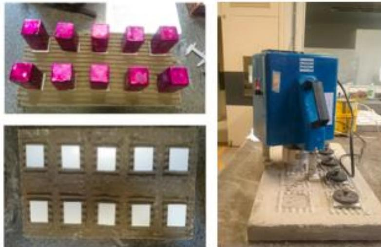
Figura 16: Procedimento Tempo em Aberto e Resistência de Aderência à Tração
