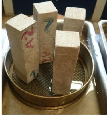
Figura 15: Procedimento Absorção de Água por Capilaridade
