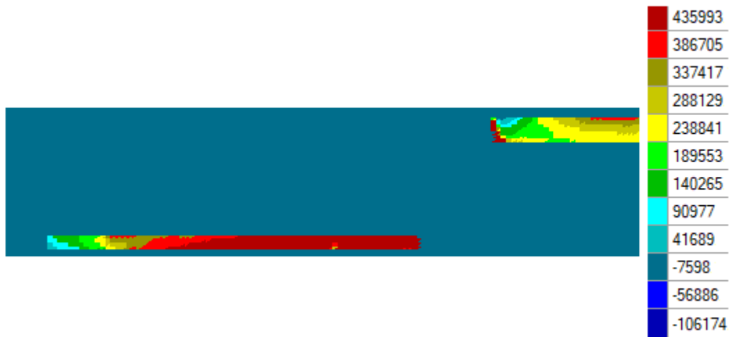
Figura 4.43 Tensão na armadura na direção x para análise não linear da configuração da Figura 4.40
