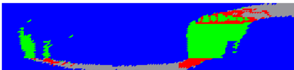
Figura 4.39 Configuração obtida via ESORC após retirada de 69% da armadura
