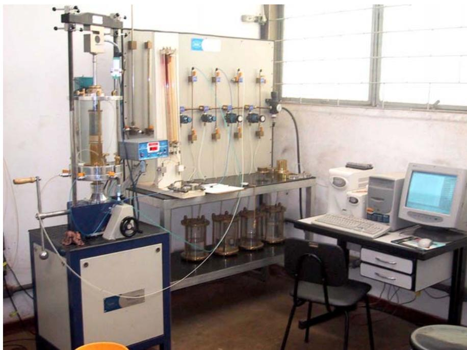
Figura 4.9 – Visão geral do equipamento utilizado nos ensaios triaxiais.
