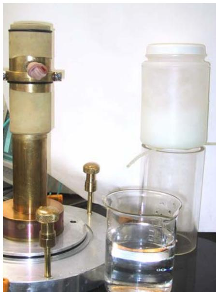
Figura 4.7 – Processo de retirada do excesso de água das camadas.
