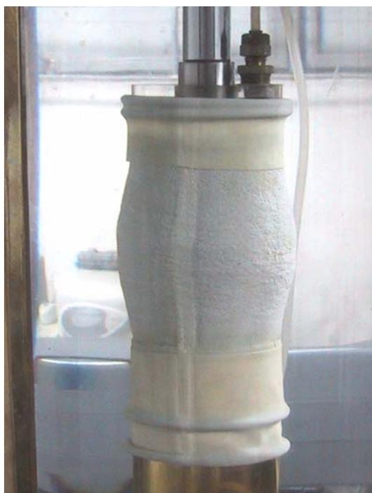
Figura 5.17 – Aspecto do corpo de prova ( $e = 0,95$ ) após o cisalhamento com tensão de confinamento de 400 kPa.
