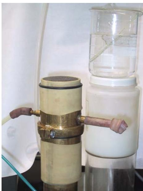
Figura 4.6 – Saturação das camadas por meio de percolação.
