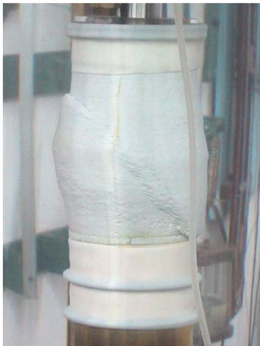
Figura 5.16 – Aspecto do corpo de prova ( $e = 0,67$ ) após o cisalhamento com tensão de confinamento de 100 kPa.
