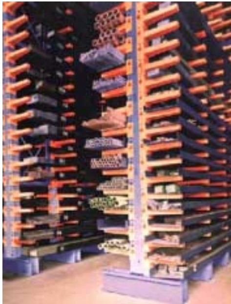
Figura 2.12 – Foto do sistema de armazenagem do tipo Cantilever , (Fiel (2002)).
