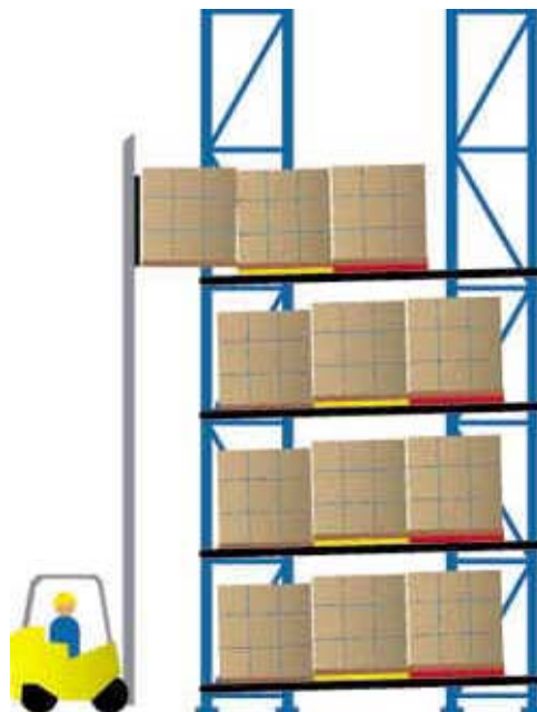
Figura 2.18 – Esquema de armazenamento no sistema Push-back ilustrando a retirada e colocação do produto, (Steel King (2002)).
