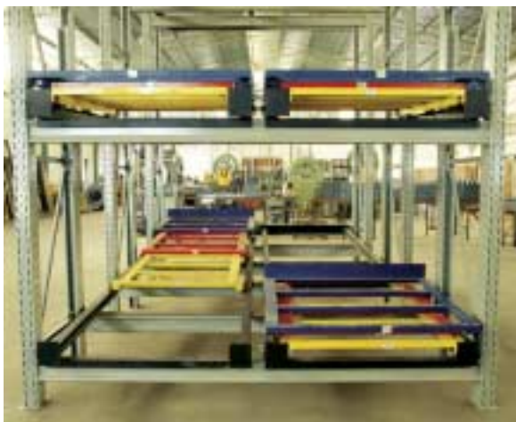
Figura 2.19 – Foto de um esquema de trilhos do sistema Push-back , (Isma (2002)).
