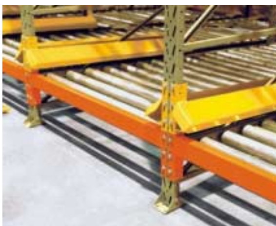
Figura 2.14 – Foto de um mecanismo de rolos no sistema de armazenagem dinâmico, (Águia (2002)).
