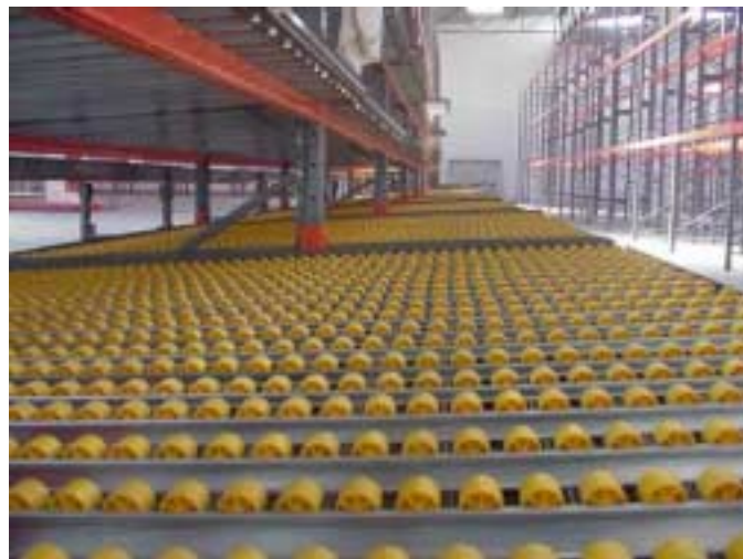
Figura 2.17 – Foto de um esquema de rodas ao longo dos trilhos, (Sofima (2002)).
