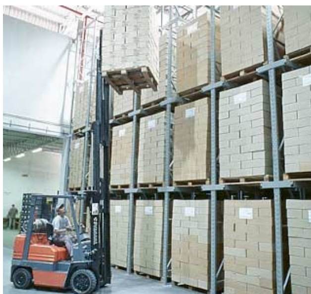
Figura 1.1 – Foto do sistema de armazenagem industrial do tipo Drive-in , (Águia (2002)).
