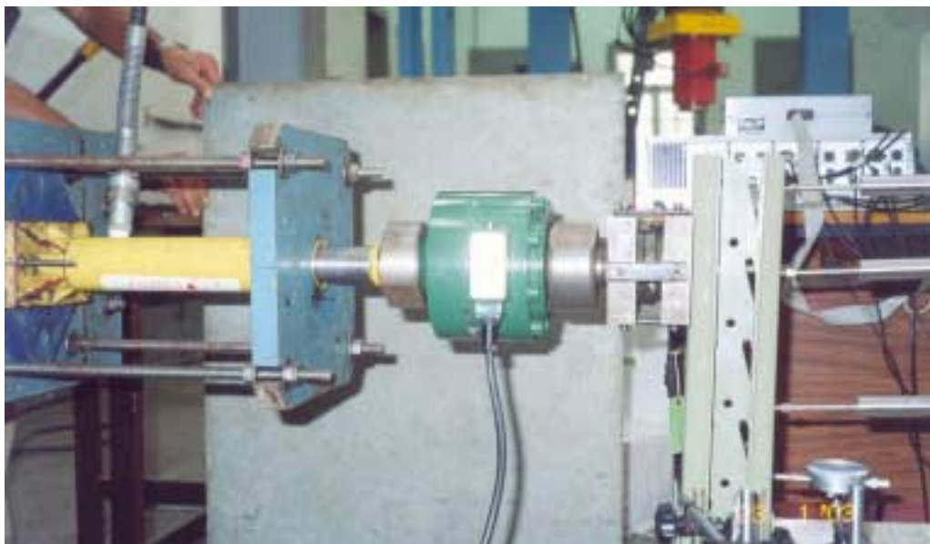
Figura 5.4 – Foto do ensaio realizado para a determinação da rigidez da ligação coluna-placa de base mostrando o posicionamento do atuador hidráulico, da célula de carga, dos transdutores de deslocamento e relógio.
