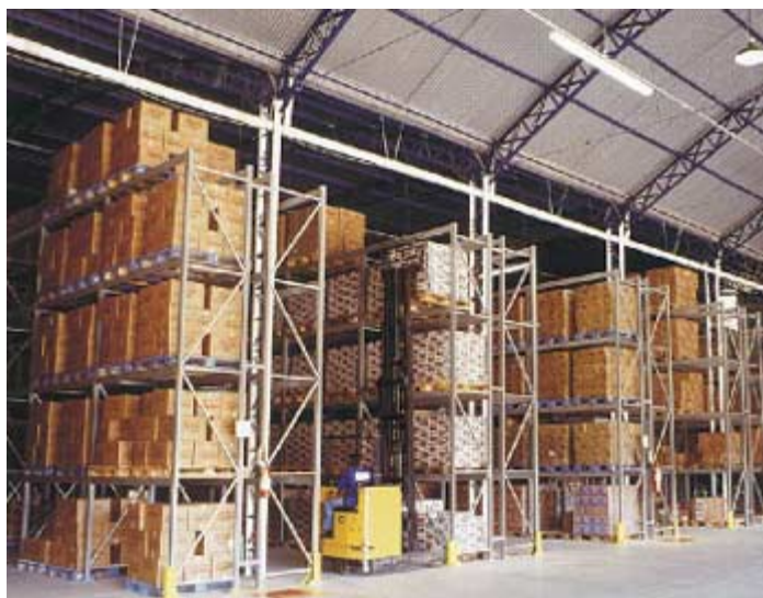
Figura 2.7 – Foto do sistema de armazenagem industrial do tipo Porta-pallets , (Altamira (2002)).
