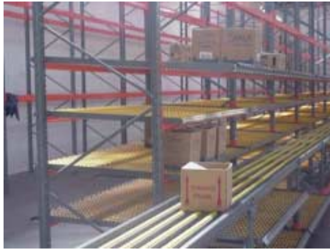
Figura 2.16 – Foto do sistema de armazenagem do tipo Flow-rack , (Sofima (2002)).
