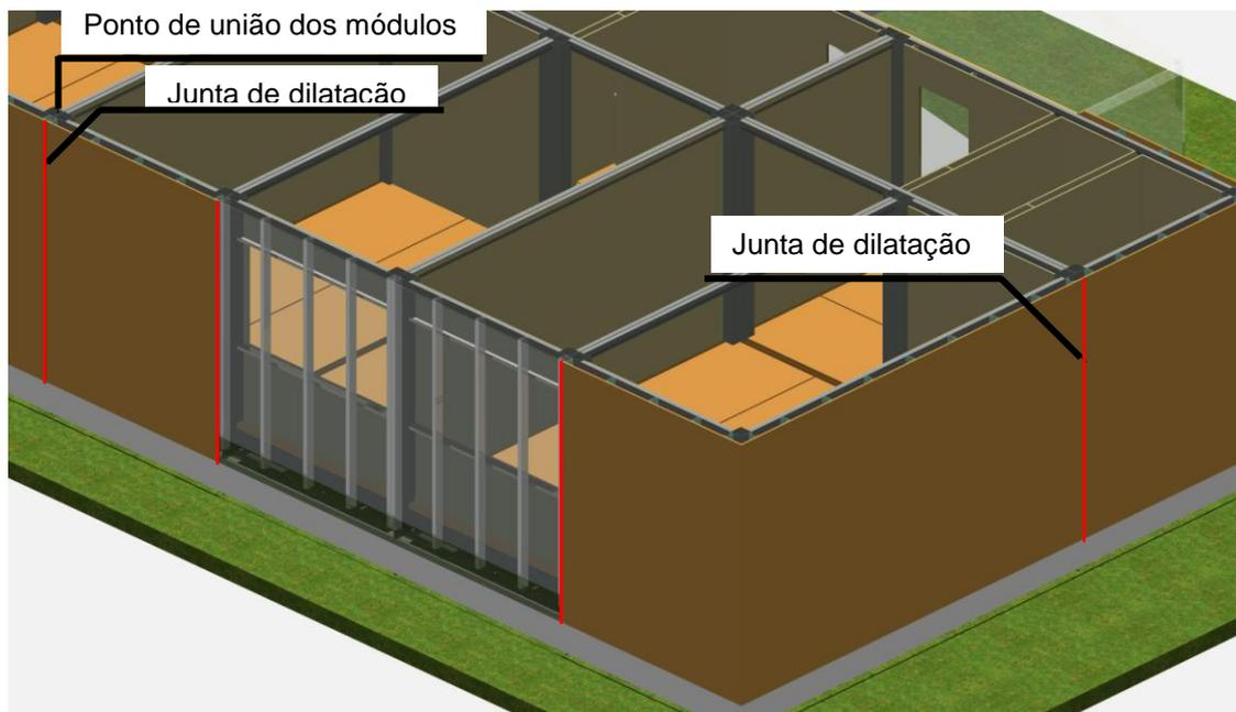
Figura 6.30: Vista da localização das juntas verticais de dilatação nos encontros dos módulos.
