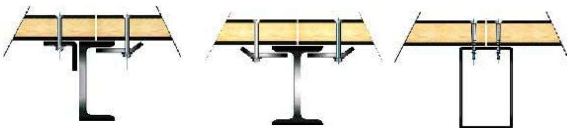
Figura 4.29 - Esquema do sistema de fixação do Painel Wall conforme o sistema estrutural
