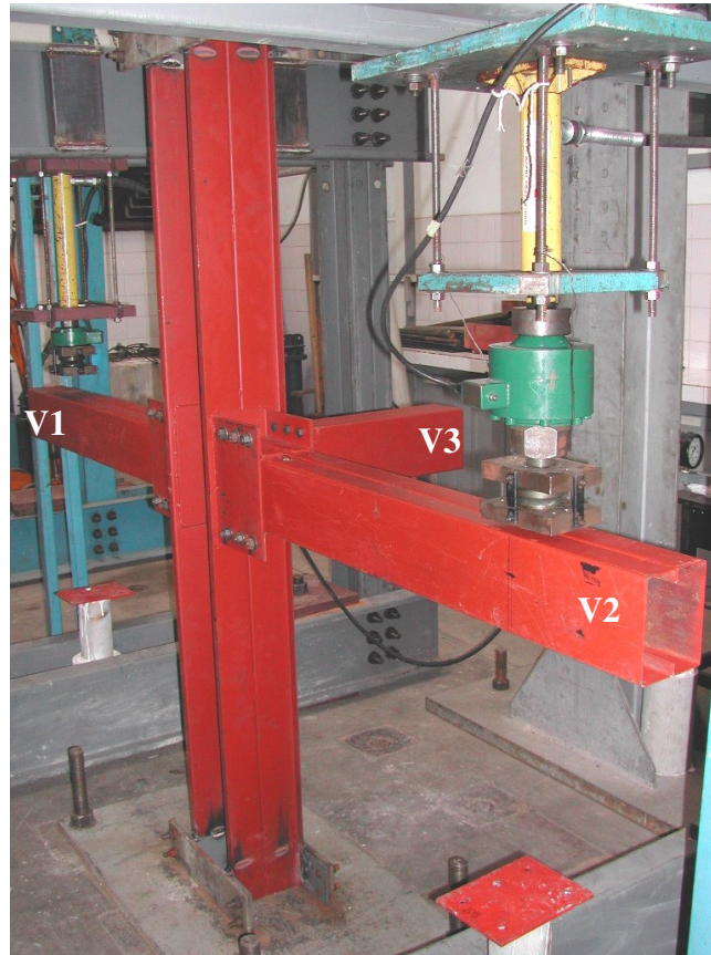
Figura 3.9 – Foto da montagem da coluna e das vigas do Protótipo B-SE.
