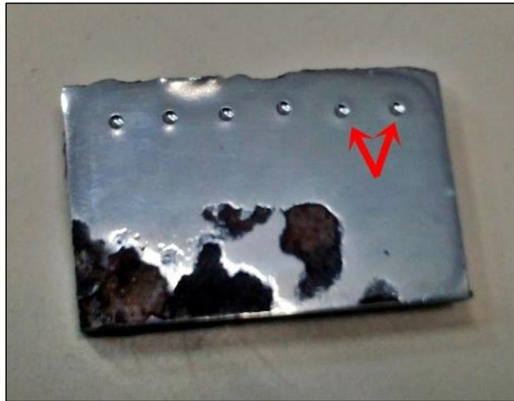
**Figura 3.5** – Amostra após ensaio de dureza Brinell (setas nas indentações realizadas)
