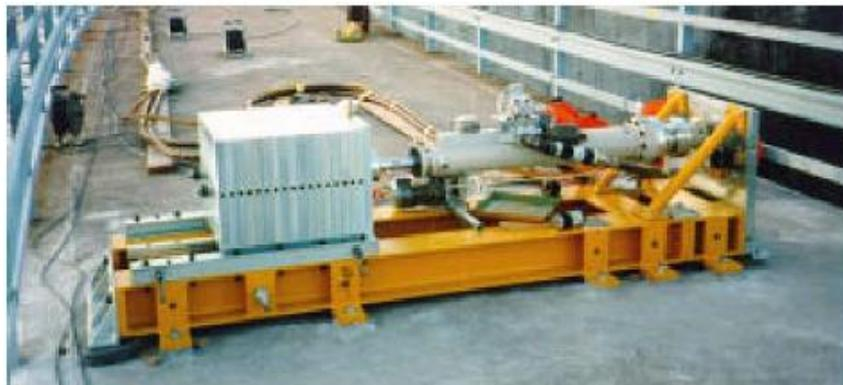
FIGURA 2 - Excitador servo hidráulico utilizado no EMPA. FONTE – CANTIENI, 2001.
