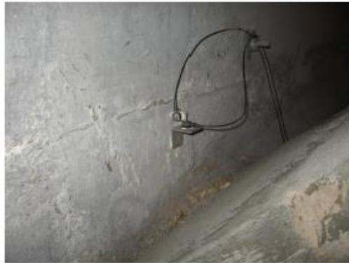
FIGURA 45 - Acelerômetros posicionados. FONTE – Cury, 2010.
