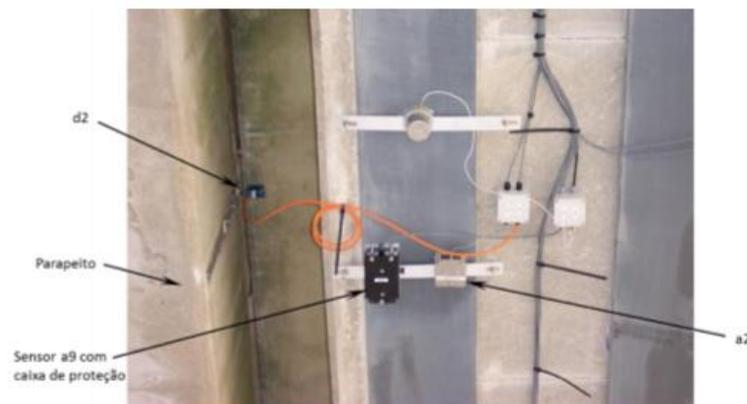
FIGURA 73 - Vistas dos sensores a2, a9 e d2. FONTE – CURY, 2010.
