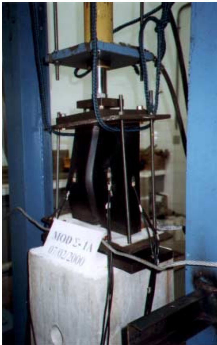
Foto 5.1- Mecanismo de colapso do perfil MOD \Sigma -1A.
