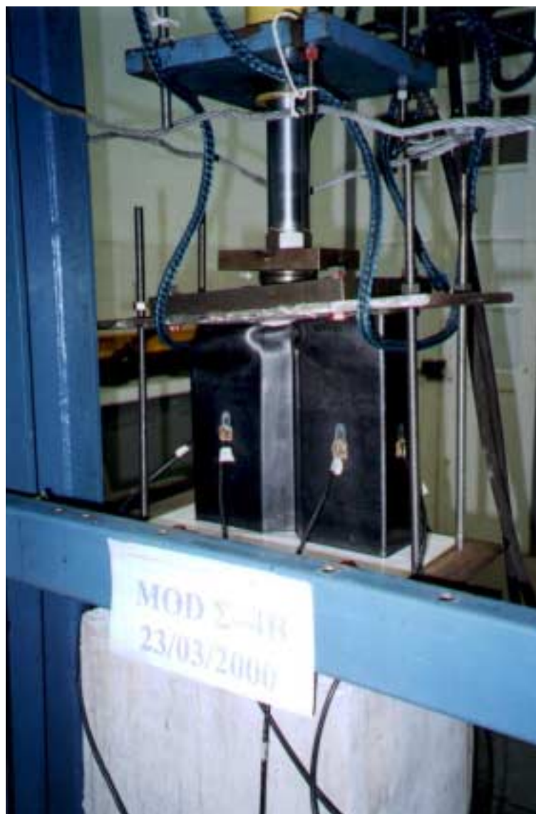
Foto 5.11- Mecanismo de colapso do perfil MOD \Sigma -4B.
