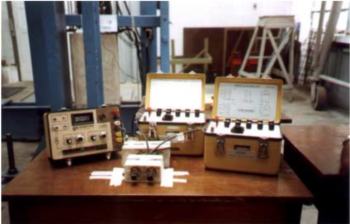
Foto 4.4- Detalhe do equipamento utilizado para aquisição das leituras dos extensômetros.
