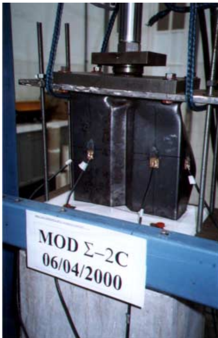
Foto 5.6- Mecanismo de colapso do perfil MOD \Sigma -2C.
