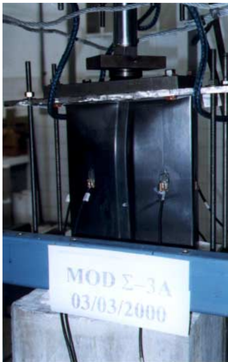
Foto 5.7- Mecanismo de colapso do perfil MOD \Sigma -3A.
