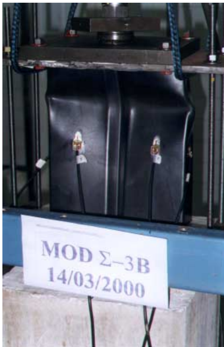
Foto 5.8- Mecanismo de colapso do perfil MOD \Sigma -3B.
