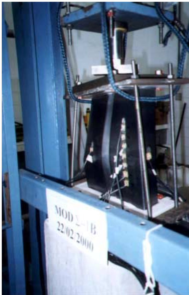
Foto 5.2- Mecanismo de colapso do perfil MOD \Sigma -1B.
