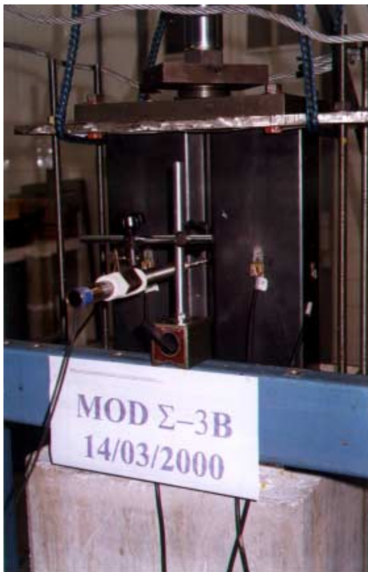
Foto 4.2- Vista da instrumentação ao longo do comprimento do perfil.
