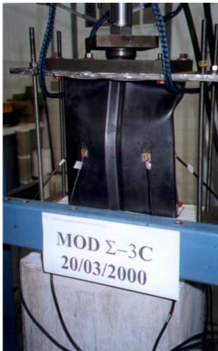
Foto 5.9- Mecanismo de colapso do perfil MOD \Sigma -3C.
